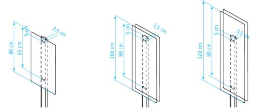
En caso de actualización de la placa a un poste ya instalado, el excedente superior sin fijación al poste ("volado") no podrá superar 1/3 del alto de la placa.
